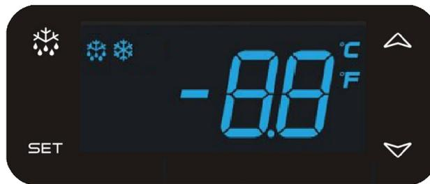
Der Regler ist voreingestellt für den Schrank und normalerweise es ist nicht notwendig die Einstellung zu regulieren. Bei Anschließen zeigt das Display die aktuelle Temperatur im Schrank.
