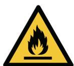
Kølemøblet indeholder det energirigtige og ikke ozonedbrydende kølemiddel R600a/R290. Da R600a/R290 er en brandfarlig gasart, er det vigtigt, at kølekredsløbet ikke beskadiges under transport og ved installering.
